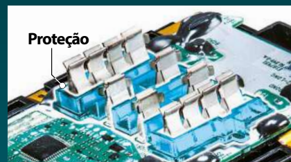
Estrutura de proteção dos circuitos e terminais A parede de proteção protege os circuitos e terminais contra água e poeira.
